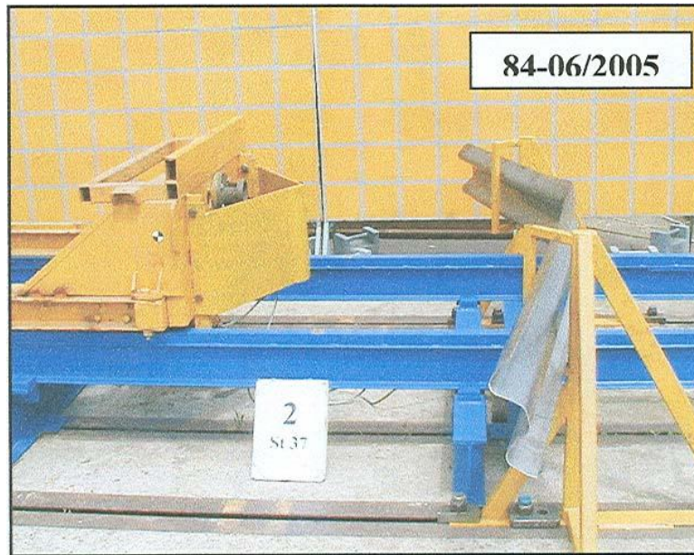
11. ábra. DP01-jelű acélból készült autópályakorlát-elem töréstesztje
